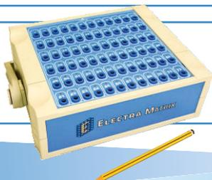
**Electra** esiste anche nella versione **Matrix**, con unità di energizzazione e conversione A/D di tutti i canali concentrata, anziché distribuita lungo i cavi. Ideale per applicazioni con cavi sommersi o interrati, a piccola scala e in alta risoluzione, per es. su manufatti archeologici ecc.
